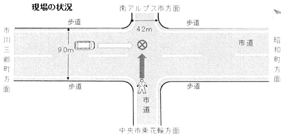
規制：【車道】速度50km/h（指定）、はみ出し禁止、駐車禁止
